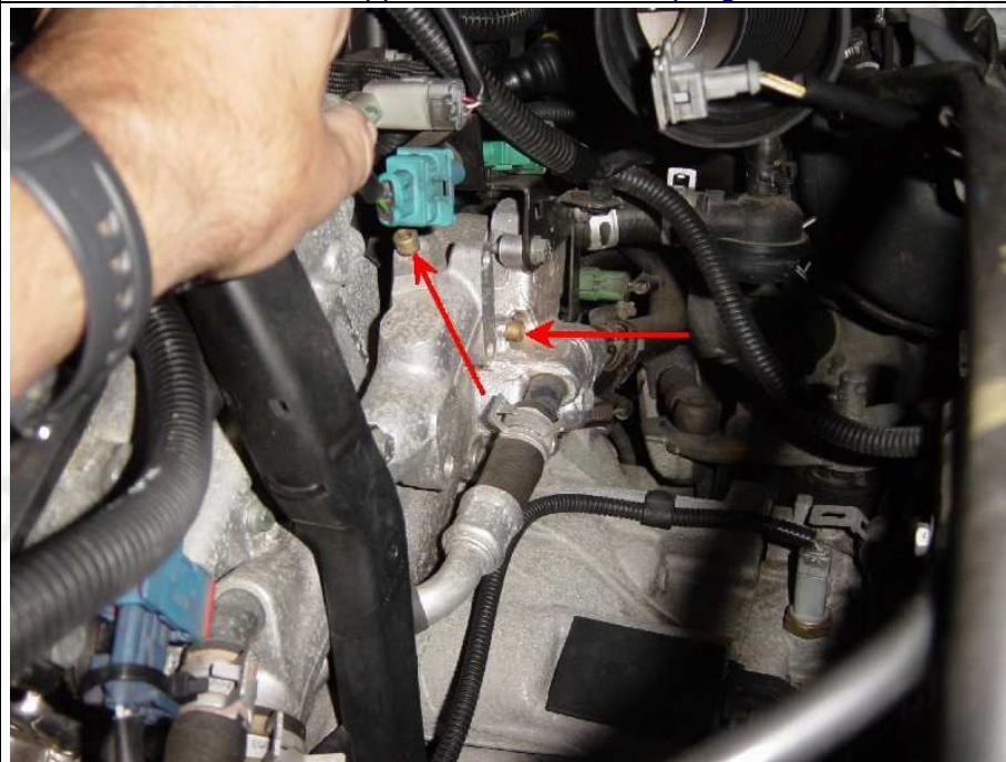
Vue rapprochée des vis de purge
