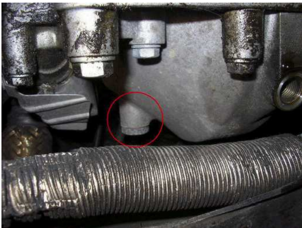
Le contacteur de marche arrière (Sur le dessus de la boîte de vitesses)
