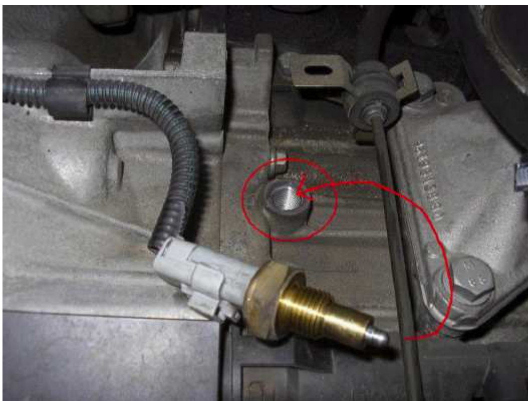
Le contacteur de marche arrière (Sur le dessus de la boîte de vitesses)
